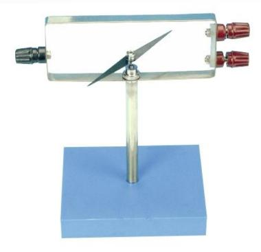
Permet de démontrer qu'un conducteur parcouru par un courant électrique produit un champ magnétique. L'aiguille de 75 mm de long est montée sur chape agate et l'ensemble est supporté par une base en plastique. Dimensions base :  $130 \times 50$  mm.
