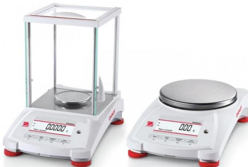
Afficheur sur deux lignes - Écran à cristaux liquides (LCD) rétroéclairé
