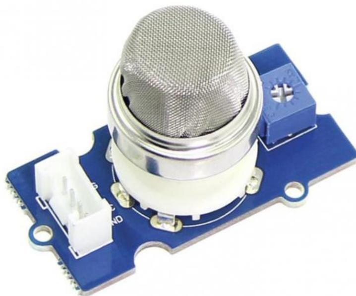
Module pouvant détecter des fuites de gaz : fumée, GPL, butane, méthane, alcool, hydrogène
