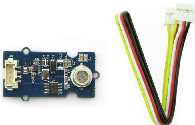
Module détectant des gaz comme le monoxyde de carbone, l'acétone, l'alcool, le formaldéhyde et d'autres gaz.
