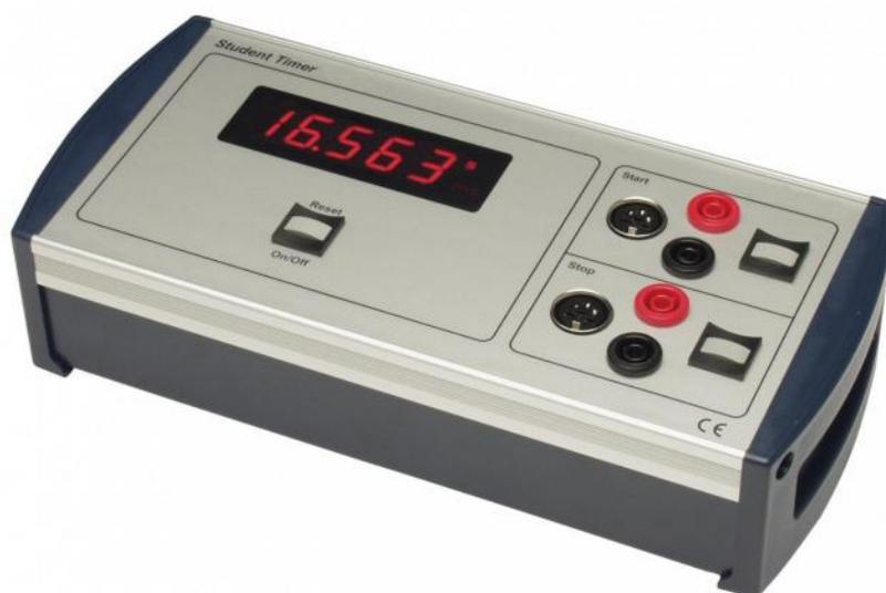
Chronomètre numérique permettant d'effectuer des mesures pour des expériences de chute libre ou sur le banc à coussin d'air.
