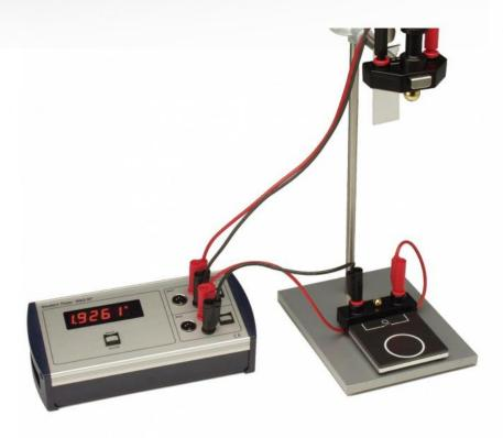
Cet appareil est conçu pour être utilisé avec un compteur électronique afin de déterminer le temps de chute d'une bille en chute libre.
