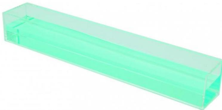
Cette cuve transparente a été conçue spécialement pour une utilisation avec le banc à ultrasons air/eau.
