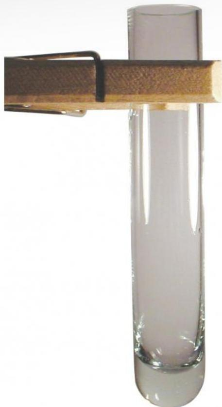
Éprouvette en verre ordinaire épais permettant la récupération des gaz et de certaines réactions explosives.
