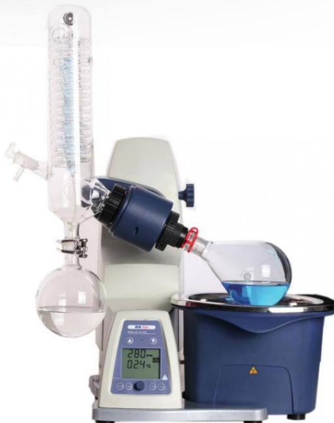
Ce modèle d'évaporateur rotatif intègre un panneau de contrôle détachable qui devient alors la télécommande de l'équipement. Un grand écran LCD permet de contrôler de nombreux paramètres comme la vitesse, la température, le temps de fonctionnement.
