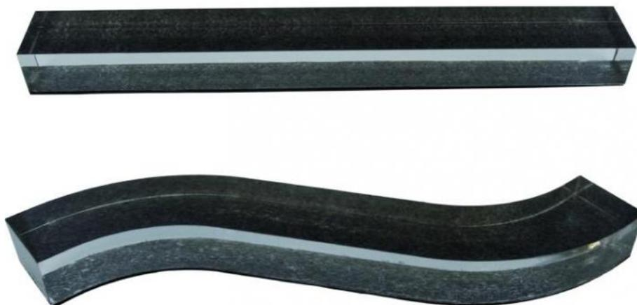
Modèles de fibre mettant en évidence la réflexion totale dans une fibre optique.
