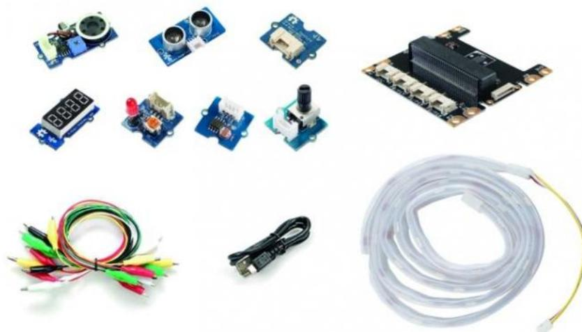
Kit de démarrage Grove composé d'une platine Shield à connecter sur une carte micro:bit (non incluse) et de plusieurs modules de base.
