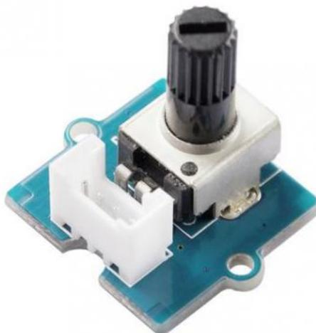
Variation de la tension grâce à une résistance variable de 10 k $\Omega$
