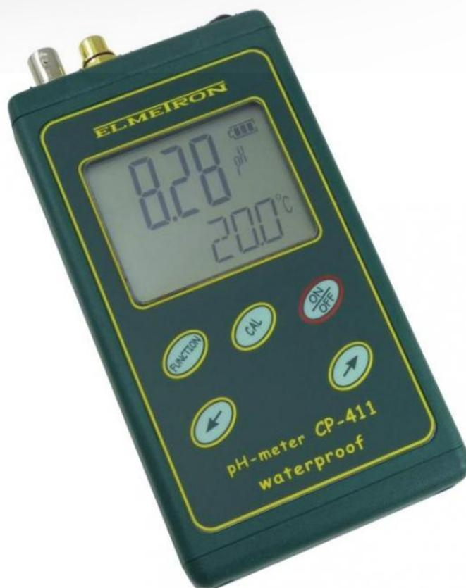
pH-mètre / millivoltmètre / thermomètre monté dans un boîtier étanche IP66
