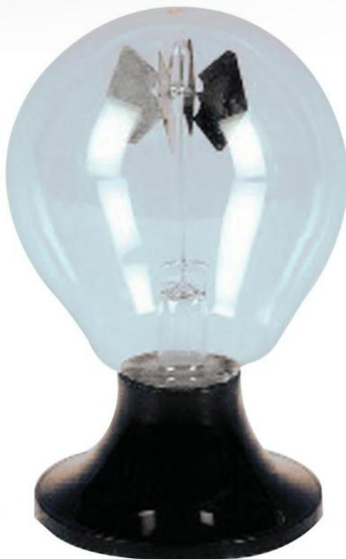
Lorsque les rayons lumineux atteignent les ailettes du radiomètre, celles-ci se mettent à tourner. Une face des ailettes est noire, l'autre blanche.
