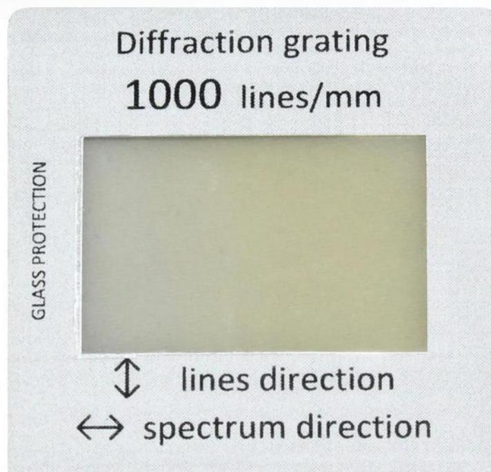
Réseaux de traits montés dans des cadres de diapositives et protégés par des plaques en verre, parfaitement appropriés pour des expériences en cours ou en TP.
