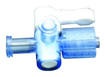
Vanne 3 voies particulièrement adaptée pour l'expérience de la loi de Mariotte. La première voie (Luer Lock femelle) se connecte sur une seringue Luer Lock, la seconde reste libre (pression atmosphérique), et la troisième (Luer Lock mâle) peut-être reliée à un manomètre via un adaptateur Luer lock femelle.
