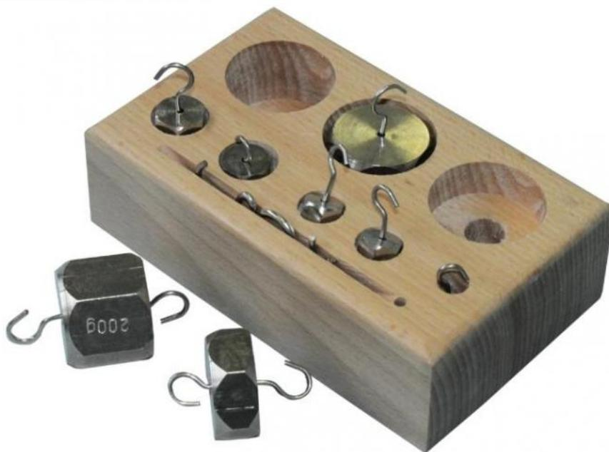
Série de 11 masses en laiton totalisant 500 g, munies de double crochets pour suspension.
