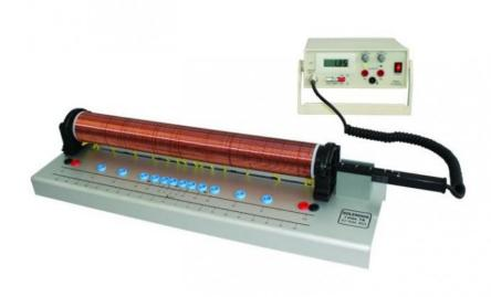
Solénoïde permettant de vérifier les lois électromagnétiques en faisant varier la longueur de la bobine, l'intensité ou encore le nombre de spires.
