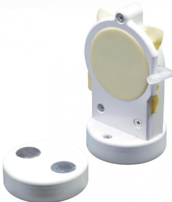
Ce manoscope consiste en une capsule avec membrane de diamètre 45 mm fixée sur un support magnétique et muni d'un raccord pour tuyau pour la raccorder à un dispositif de mesure de pression. Une bague en plastique magnétique permet à l'utilisateur de déplacer la sonde dans l'eau depuis l'extérieur de la cuve sans avoir à mettre les mains dans l'eau.
