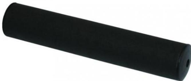
Ce spectroscope est constitué d'un tube en plastique rigide de diamètre 30 mm avec à ses extrémités une fente fine et un réseau de 140 traits/mm.
