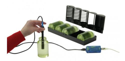
Ce système d'étude permet une mesure fiable et répétitive de l'intensité photosynthétique en fonction de l'intensité lumineuse. Composé de 5 bouteilles en plastique de 250 ml et d'un support en plastique, ce système permet un contrôle très précis de la quantité de lumière reçue dans chaque récipient et permet ainsi de réaliser des analyses précises.
