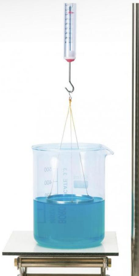
Anneau d'aluminium à lames et trois fils reliés à un crochet permettant de déterminer à l'aide d'un dynamomètre la tension superficielle d'un liquide.
