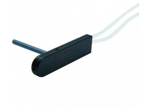
Ce dispositif permet d'illustrer le fonctionnement d'un tube de Pitot utilisé pour la mesure de la vitesse d'écoulement d'un fluide. Le tube comporte 2 orifices : une à son extrémité arrondie et l'autre sur le dessus. Ceux-ci sont reliés à 2 tubes PVC souples permettant la mesure de la différence de pression entre ces 2 points à l'aide d'un manomètre à eau ou d'un manomètre différentiel (non fournis) lorsque le tube est placé dans un courant d'air.
