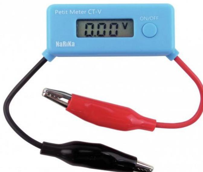
Voltmètre numérique compact avec câbles et pinces crocodiles intégrés. Il suffit de connecter les pinces à l'endroit désiré et de lire simplement la tension mesurée en temps réel.
