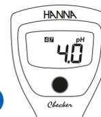
L'instrument revient en mode mesure et les symboles des points étalonnés seront affichés.
