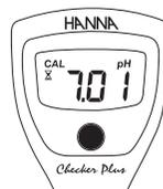
Si la solution tampon pH 7,01 est utilisée pour le premier point le tampon est reconnu avec le sablier clignotant.
