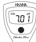
Lorsque "7.01" clignote, placer le bout de l'électrode dans une solution tampon pH 4,01; 7,01 ou 10,01.
