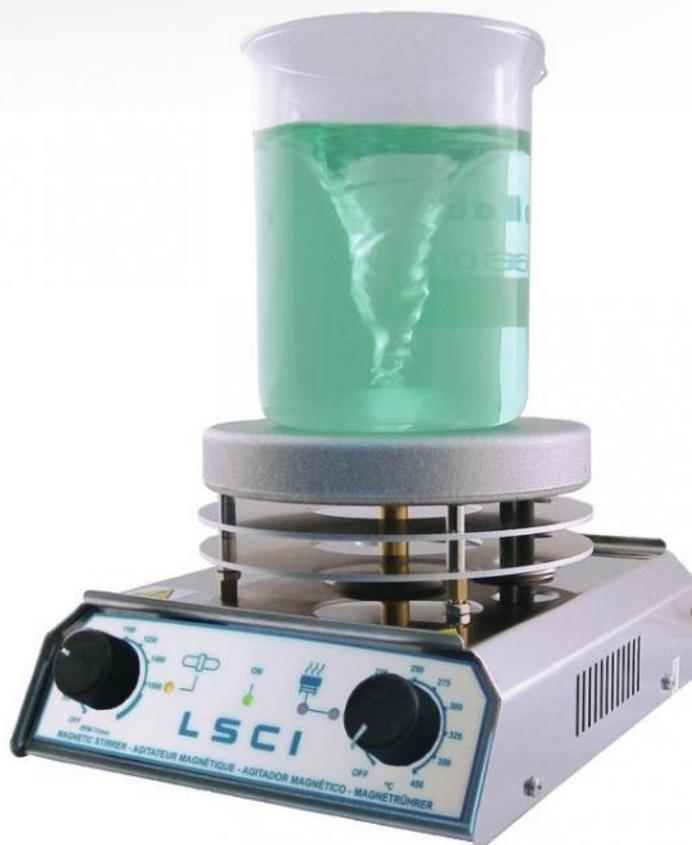
Appareil multifonctions : agitateur magnétique, plaque chauffante, chauffe-ballons (adaptateurs en option)
