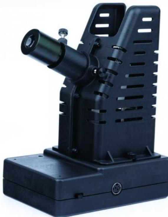
**Le point de fusion est une propriété importante pour déterminer l'identité et la pureté des composés. L'oculaire grossissant 3x intégré permet aux étudiants d'observer facilement le processus de fusion.**
