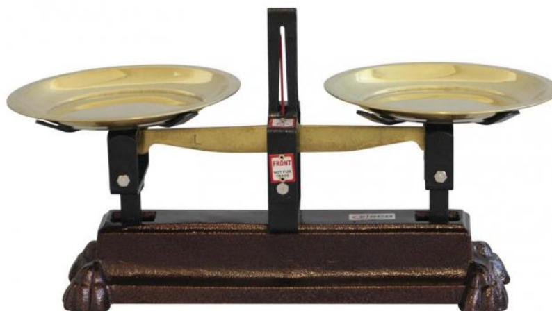
Balance avec 2 plateaux, avec couteaux en acier traité et coussinet agate.
