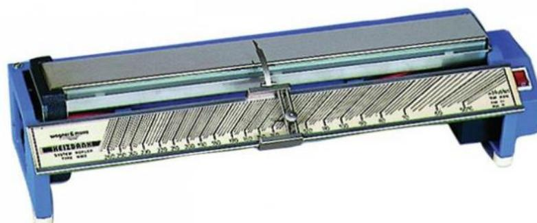
Appareil permettant de déterminer rapidement un point de fusion. Un dispositif de chauffage unilatéral permet d'obtenir un gradient de température quasi linéaire. La température se lit au moyen d'un curseur sur une échelle graduée de +50 °C à +260 °C.
