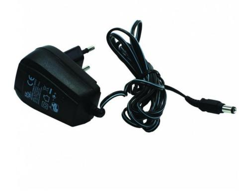
Blocs secteurs à découpage à tension fixe. Tension d'entrée: 100-240VAC 50/60Hz. Sortie stabilisée sur fiche 5,5 x 2,1 mm. Protection contre court-circuit et surcharge.
