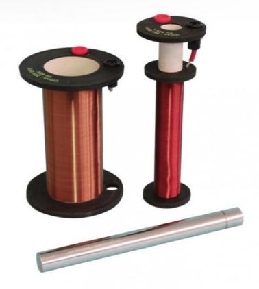
Appareil composé de 2 bobines (inductrice et induite) et d'un noyau de fer doux, illustrant parfaitement l'expérience de Faraday.
