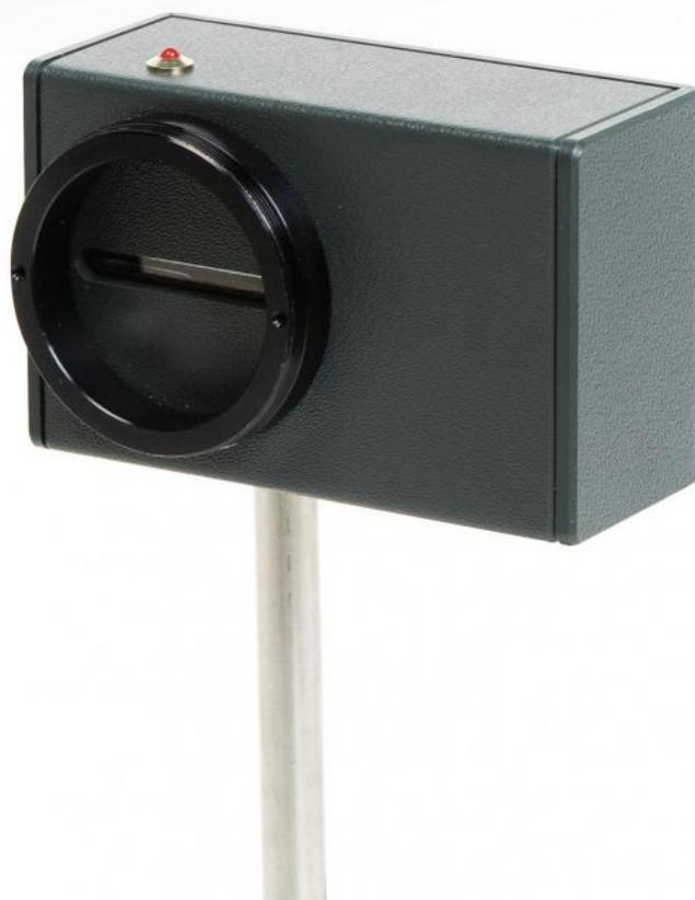
La caméra CALIENS Lycée permet d'effectuer l'échantillonnage et l'exploitation des figures lumineuses grâce à un logiciel simple d'utilisation. Les mesures de diffraction et d'interférences deviennent simples, précises et intuitives grâce à une série de curseurs et à une visualisation rapide. Temps d'intégration réglable pour plus de précision et de confort.
