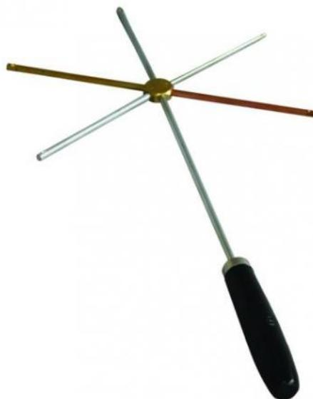
Appareil mettant en évidence la différence de conductivité thermique selon les matériaux : laiton, cuivre, acier inoxydable, aluminium et fer.
