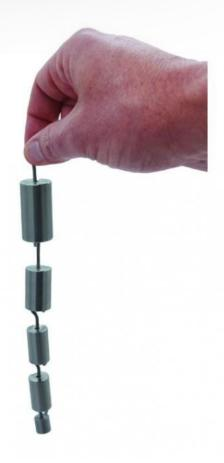
Masses en acier inoxydable proposées au détail ou en série complète de 9 masses (10g, 2x20g, 50g, 100g, 2x200g, 500g, 1000g) avec un coffret en bois de rangement.
