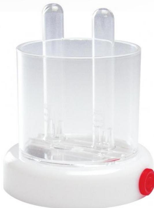
Cuve en matière plastique résistante aux acides, permettant par exemple de réaliser l'électrolyse d'une solution d'acide sulfurique.
