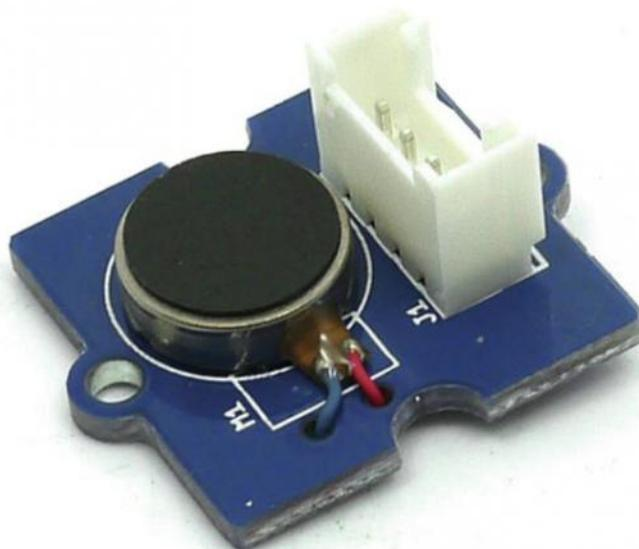
Très facile à piloter, il entre en vibration lorsque l'entrée logique est "Haute"
