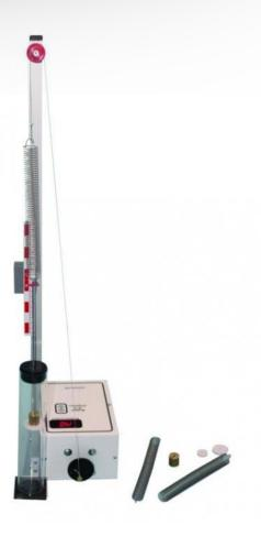
Le dispositif est livré complet et permet les études statiques et dynamiques des ressorts : Loi de Hooke, oscillations libres et forcées, amortissement, etc...
