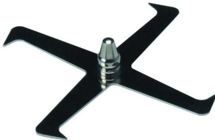
Le tourniquet électrostatique permet de mettre en évidence le pouvoir des pointes. Les charges accumulées sur les pointes s'échappent en ionisant l'air et propulsent ainsi les bras du tourniquet qui se met alors à tourner.
