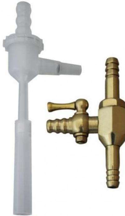
Trompe à eau en laiton avec raccord à olive
