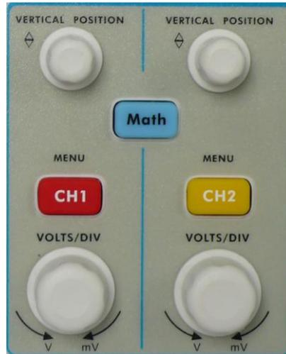
**Fig. 4-11** Zone contrôle vertical
