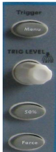
Figure 4-14 Zone contrôle déclenchement
