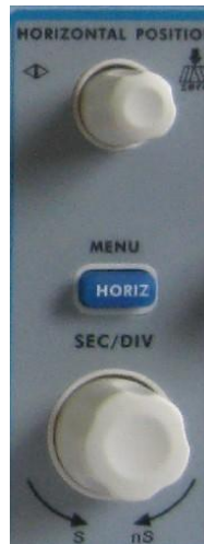
Figure 4-13 Zone de contrôle horizontal
